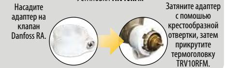
Затяните адаптер с помощью крестообразной отвертки, затем прикрутите термоголовку TRV10RFM.
